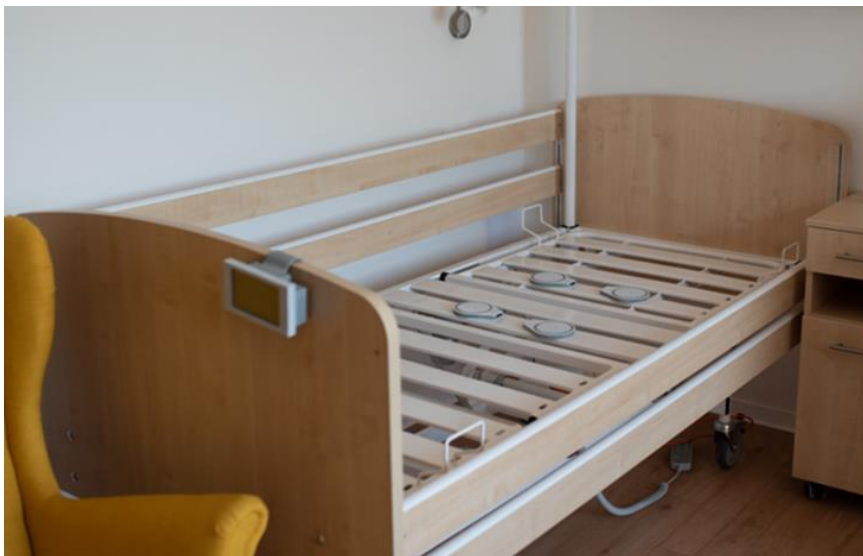
Obrázek 1. Čtyři senzory ANUME uchytené k rámu postele v původní verzi
