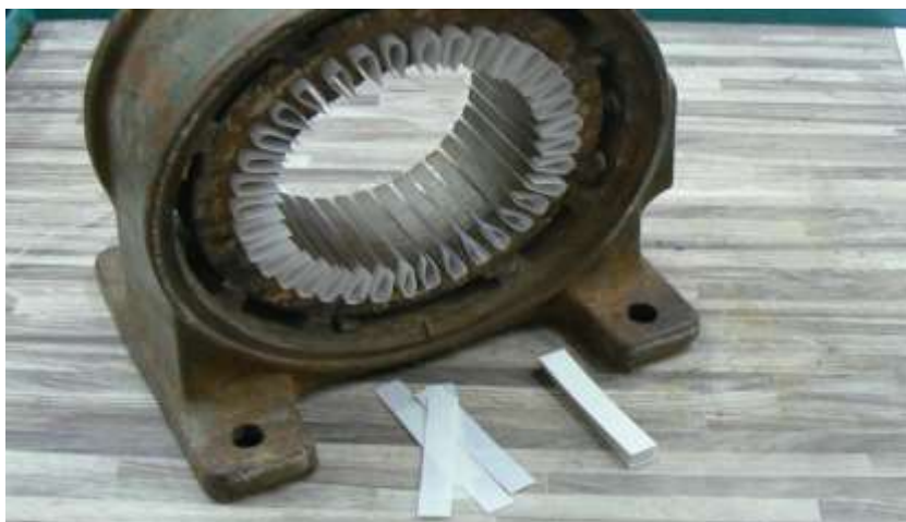
OBRÁZEK 26 VYHOTOVENÁ DRÁŽKOVÁ IZOLACE A UZÁVĚRY DRÁŽEK
