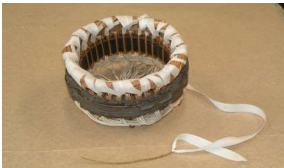
OBRÁZEK 34 ZABANDÁŽOVANÝ VĚNec STATORU PŘEKLÁDANÉHO VINUTÍ
