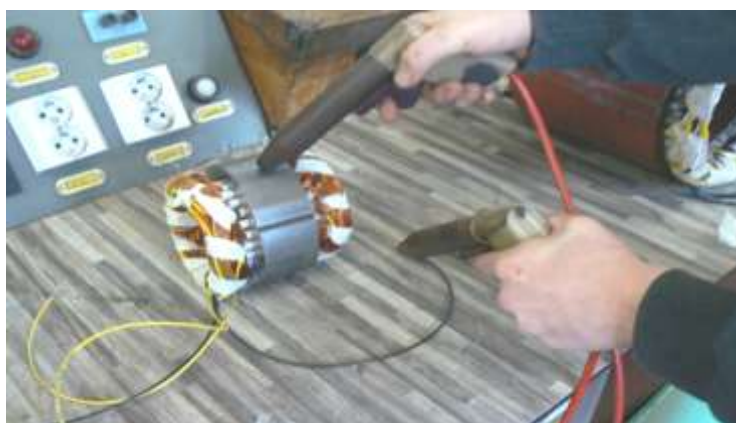
OBRÁZEK 11 ZKOUŠENÍ IZOLAČNÍHO STAVU ZVÝŠENÝM NAPĚTÍM
