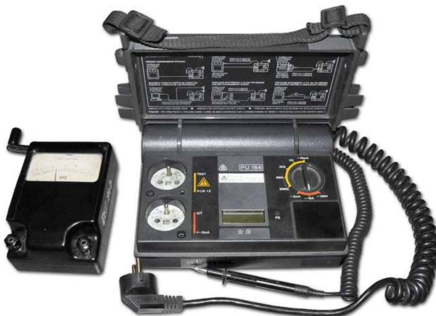
OBRÁZEK 10 STARÝ A NOVÝ MĚŘICÍ PŘÍSTROJ NA MĚŘENÍ IZOLAČNÍHO STAVU
