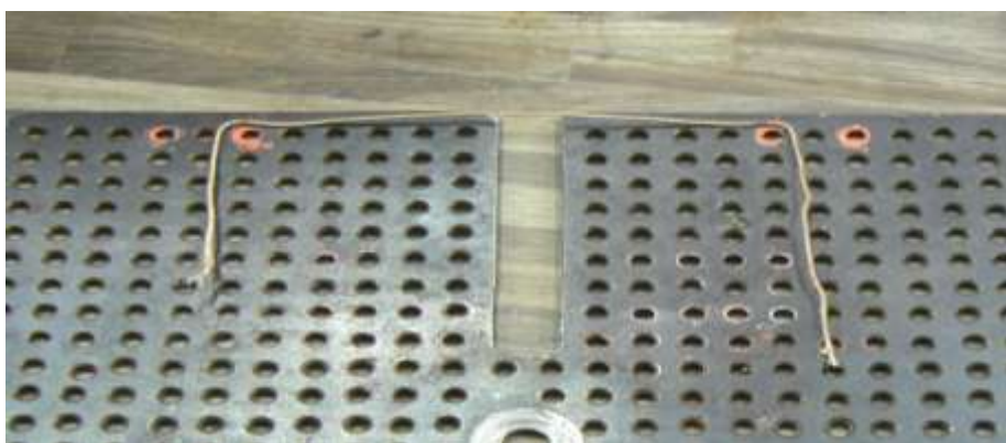
OBRÁZEK 28 ZAKRESLENÍ VELIKOSTI CÍVKY NA ŠABLONU
