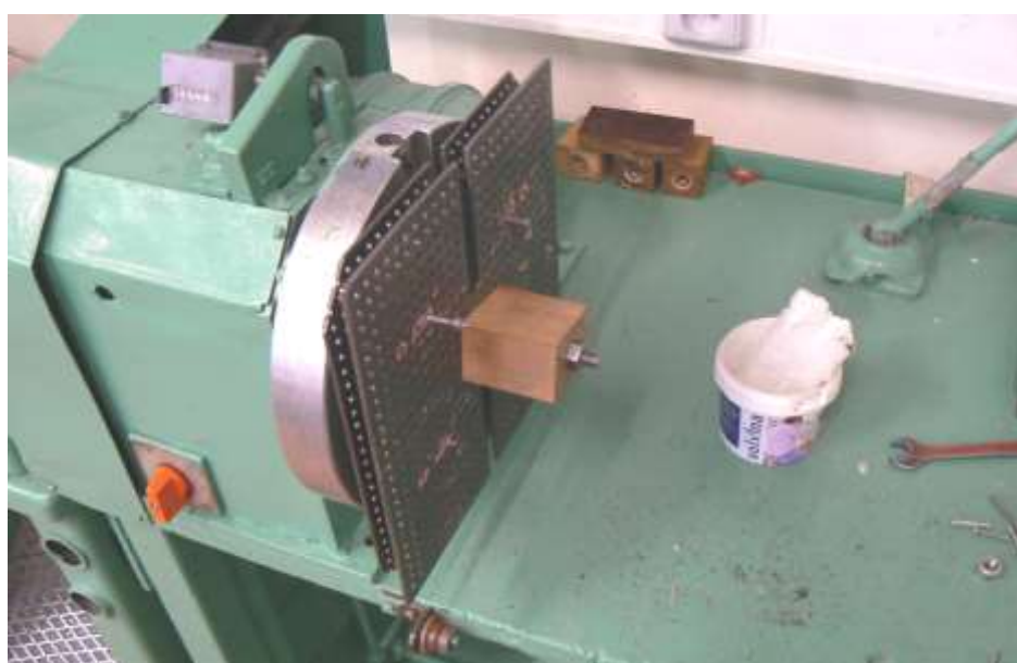
OBRÁZEK 29 UPNUTÍ ŠABLONY NA NAVÍJEČKU
