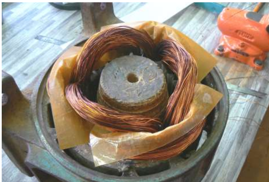
OBRÁZEK 35 PROKLADOVÁ IZOLACE SOUSTŘEDNÉHO VINUTÍ
