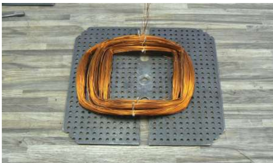
OBRÁZEK 31 NAVINUTÁ CÍVKA – TROJCÍVKA
