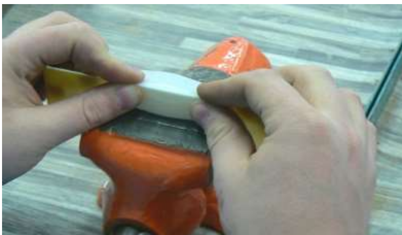
OBRÁZEK 25 OHÝBÁNÍ DRÁŽKOVÉ IZOLACE PODLE VZORU
