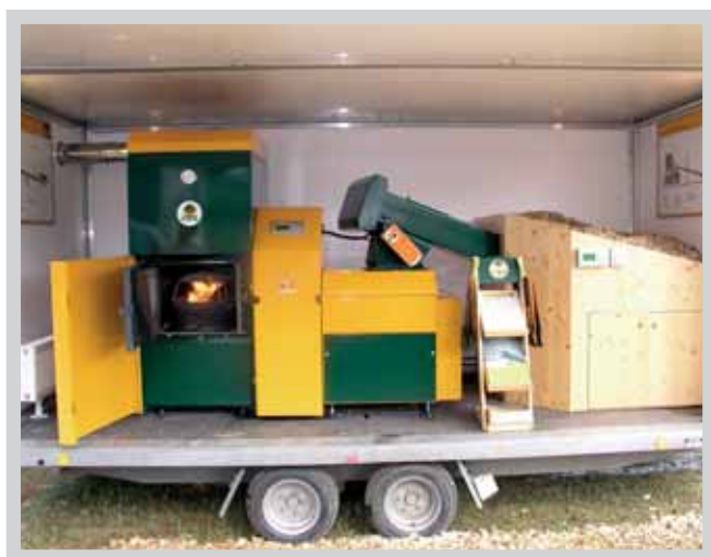
Kotel na štěpku s automatickým provozem. Foto. Karel Srdečný, EkoWATT
