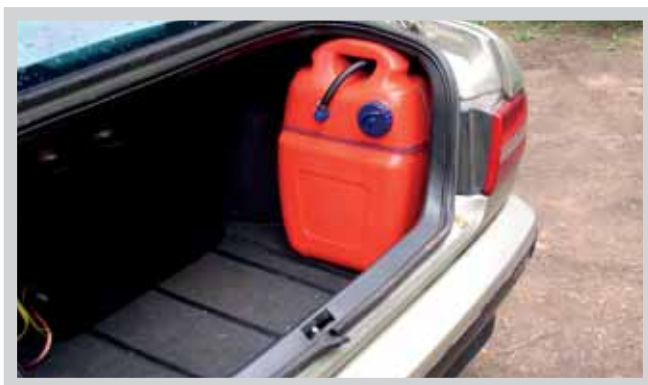
Nádrž na rostlinný olej dodatečně namontovaná do vozidla. Foto: Pavel Hasík
