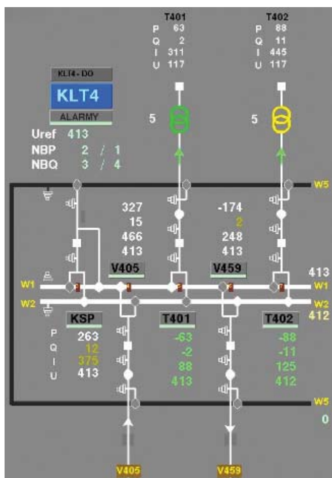
Obr. 13: Jednopólové schéma rozvodny přenosové soustavy 400 kV Kletné.
