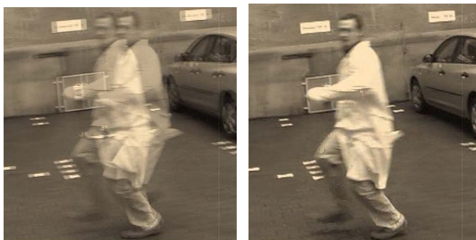
Obrázek 44: Vlevo prokládaný obraz, vpravo po odstranění prokládání
