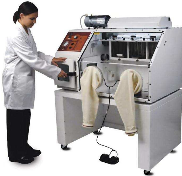
Anaerobní pracovní stanice (box) Bactron ke kultivaci a vytváření kontinuální anaerobiózy (bezkyslíkatého prostředí)
